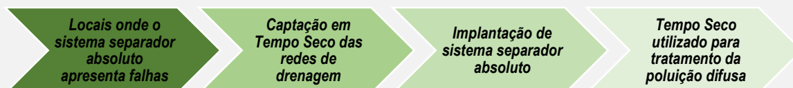
Figura A - Estágios propostos para o processo de captação e tratamento de esgotos urbanos
