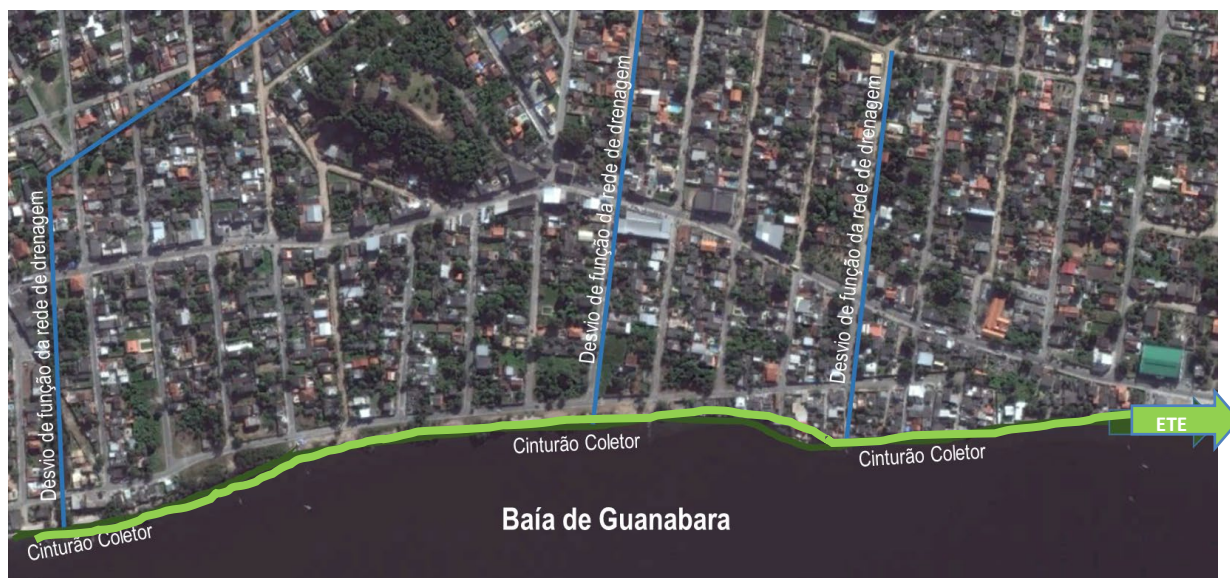
Figura I - Figura esquemática do funcionamento do Cinturão Coletor para a Baía de Guanabara
