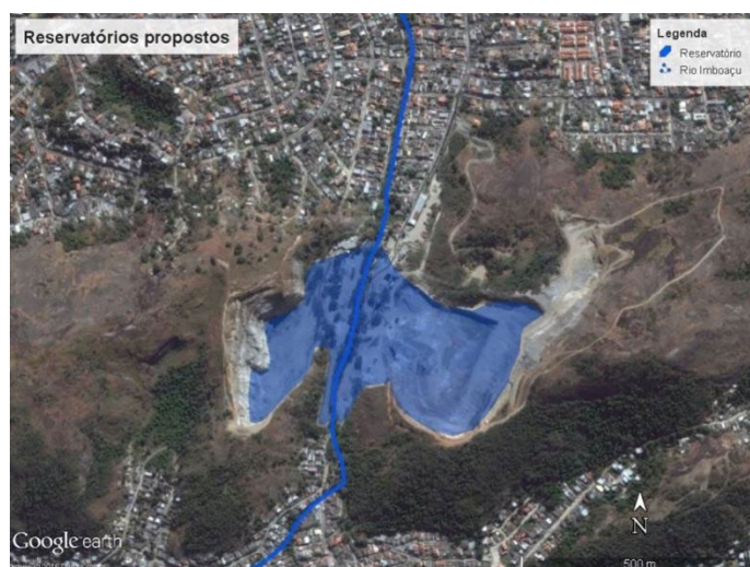
Figura 2 – Detalhes das pedreiras Carioca Ltda. e Anhanguera S/A, sugeridas para implantação de reservatórios para controle de cheias
