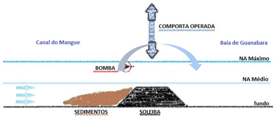
Figura 2 – Representação esquemática do sistema de comporta operada para o exutório da bacia do Canal do Manguê.
