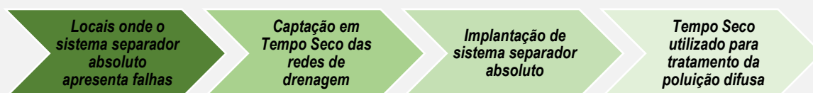
Figura A - Estágios propostos para o processo de captação e tratamento de esgotos urbanos
